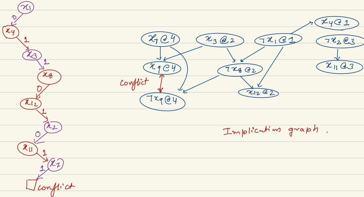
$$F: (x_1 \vee x_4) \wedge (x_1 \vee \neg x_3 \vee \neg x_8) \wedge (x_1 \vee x_8 \vee x_{12}) \wedge (x_2 \vee x_{11}) \wedge \\ (\neg x_7 \vee \neg x_3 \vee x_9) \wedge (\neg x_7 \vee x_8 \vee \neg x_9) \vee (x_7 \vee x_8 \vee \neg x_{10}) \wedge (x_7 \vee x_{10} \vee \neg x_2)$$
